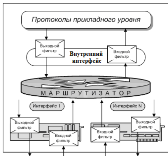
Рис. 3.18 Схема применения IP-фильтров на внутреннем и на сетевых интерфейсах маршрутизатора
