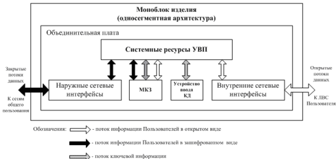
Рис. 1.1 Упрощенная схема информационного взаимодействия основных элементов изделия, исполненного в односегментной архитектуре технологии DioNIS®
