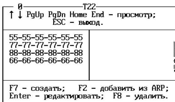
Рис. 3.28 Бланк создания и настройки записей таблицы MAC-адресов
