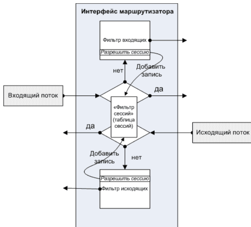
Рис. 3.26 Схема, иллюстрирующая алгоритм работы фильтра сессий
