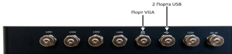
Рисунок Г.41 – Схема расположения порта VGA и портов USB
