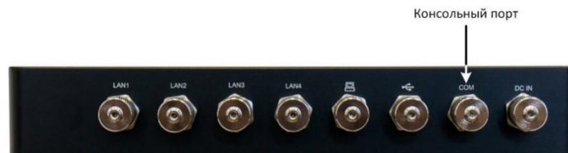
Рисунок Г.42 – Схема расположения консольного порта
