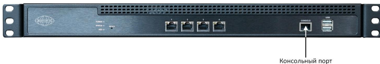
Рисунок Г.14 – Схема расположения консольного порта
