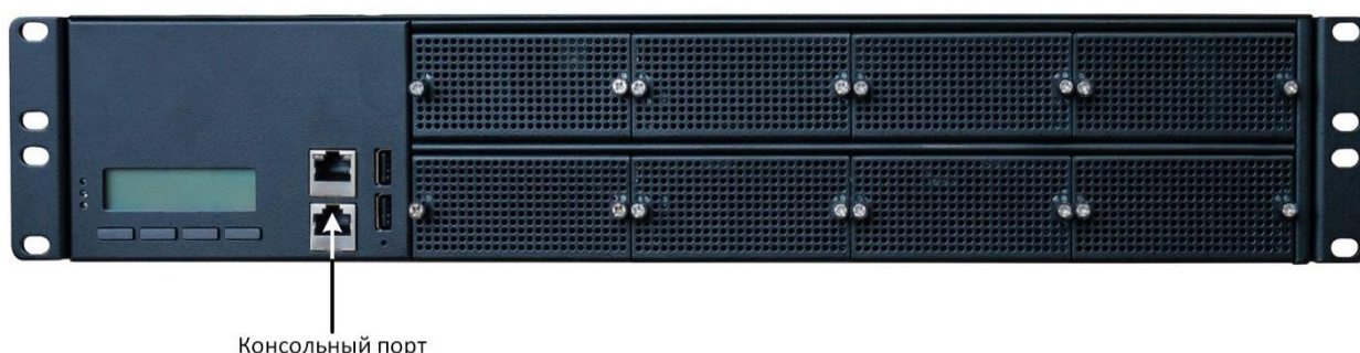
Рисунок Г.10 – Схема расположения консольного порта
