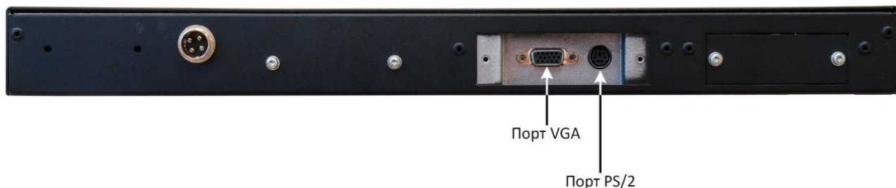
Рисунок Г.5 – Схема расположения портов VGA и PS/2
