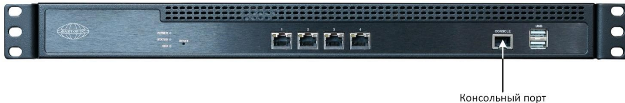
Рисунок Г.14 – Схема расположения консольного порта
