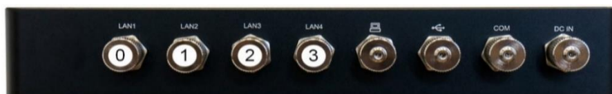
Рисунок Г.43 – Схема нумерации сетевых портов
