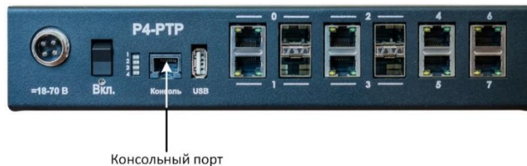
Рисунок Г.1 – Схема расположения консольного порта и нумерации сетевых портов Локально с помощью монитора, подключенного к порту VGA, и клавиатуры, подключенной к порту PS/2 (см. рисунок Г.2).
