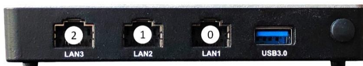
Рисунок Г.21 – Схема нумерации сетевых портов
