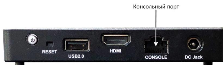
Рисунок Г.20 – Схема расположения консольного порта
