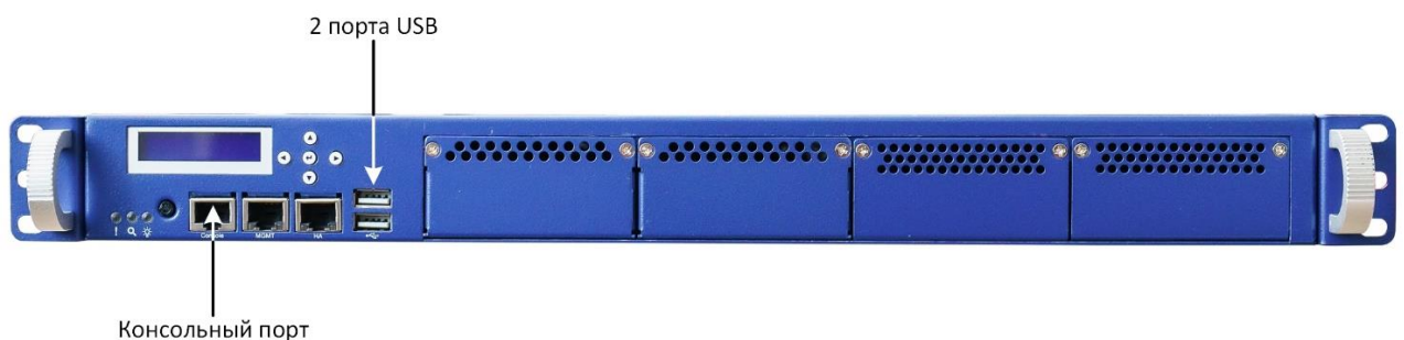
Рисунок Г.45 – Схема расположения портов USB и консольного порта.
