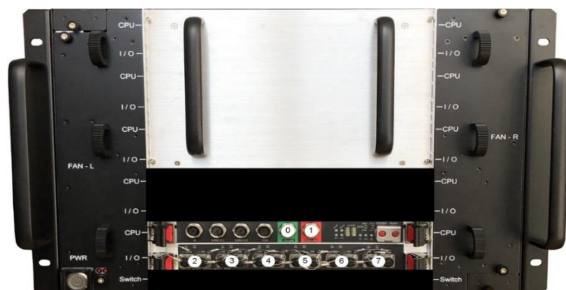
Рисунок Г.30 – Схема нумерации сетевых портов на изделии с блоком расширения 6x1000Base-X
